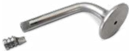
Fig. 1 Rottura violenta in corrispondenza della gola
